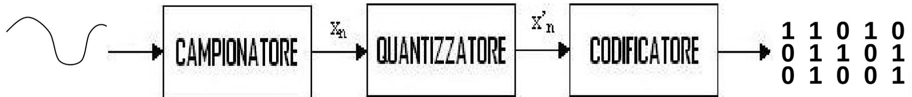
La conversione analogico-digitale trasforma un segnale analogico (valori continui in un tempo continuo) in segnale numerico (valori discreti in tempo discreto).
