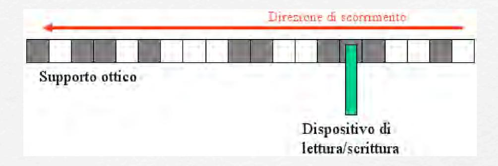
**Scrittura**: viene emesso un raggio laser che crea sottili scanalature sulla superficie del disco, creando un'alternanza di zone chiare (*intersolchi*) e scure (*scanalature*)
